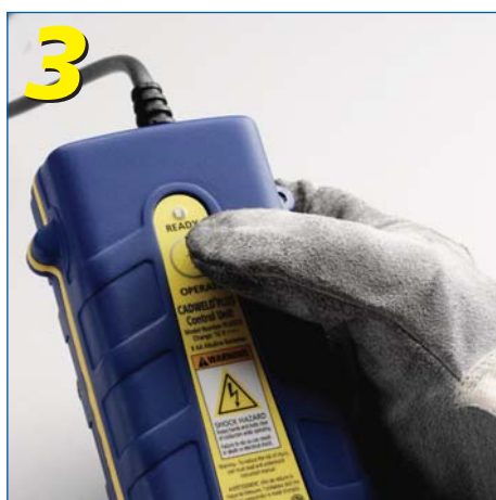
Mantenha o botão da Unidade de Controle pressionado até que ocorra a ignição
